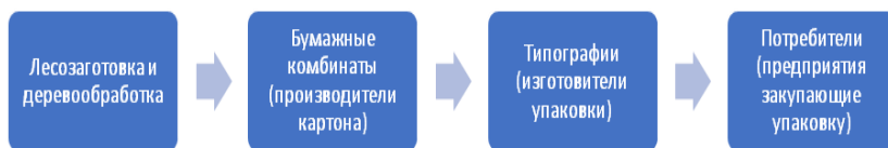
Схема 1. Стадии производства упаковки из картона
